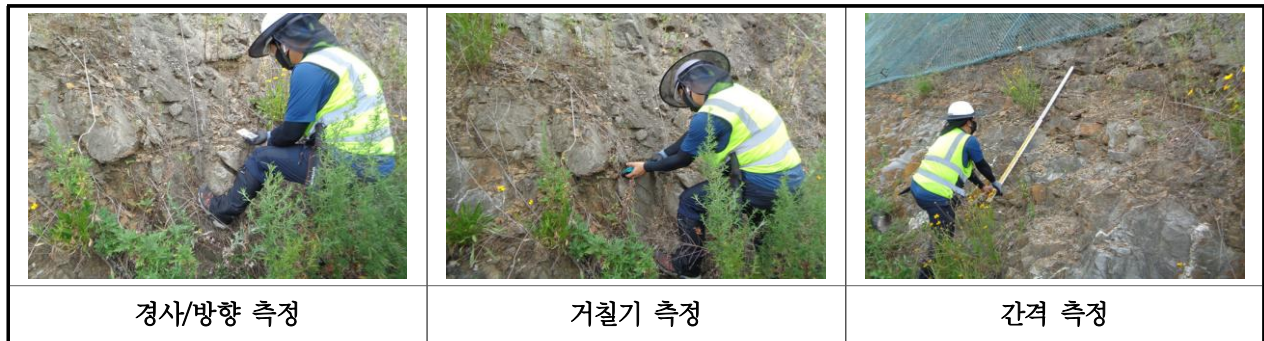
【사진 29.3.3】 불연속면 측정 현황
